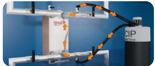
Schließen Sie die CIP-Maschine über den Ein- und Auslass an der Vorder- oder Rückseite an. Pumpen Sie die Lösung über den unteren Anschlusspunkt in den Wärmetauscher, um ein Austreten von Luft zu ermöglichen. Kehren Sie den Fluss alle 30 Minuten um.
